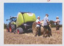
Presse bei reduzierter Zapfwellendrehzahl untersucht.
