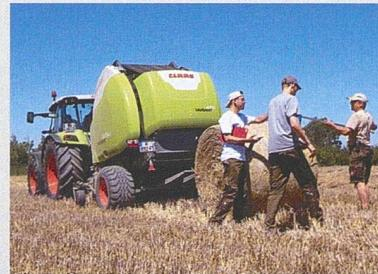
Presse bei reduzierter Zapfwellendrehzahl untersucht.
