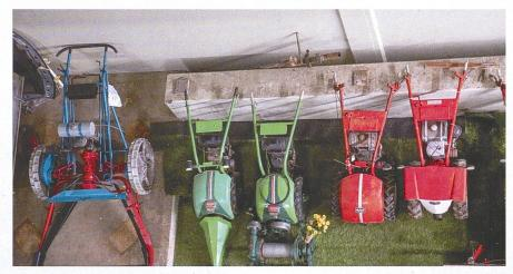
Der Aecherli Standard 1933, der Aecherli «MA 60» mit Messerbalken, der Aecherli «MA 60» mit originaler Seilwinde (auf der Haube unglücklicherweise die Antriebskeilriemen), der Aecherli «MA 65» und der Aecherli «MA 65 S» (von links nach rechts).
