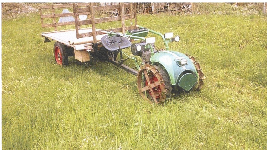
Der Aecherli «MA 60», welcher mit Stollenrädern für Vortrieb in steilem Gelände eingelöst ist (da kein Triebachswagen).
