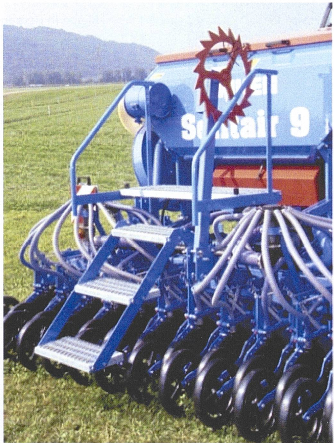
Mit den Anforderungen für sichere Aufstiege, wie hier bei dieser Sämaschine, lässt sich die Erfolgsgeschichte der Normungsarbeit eindrücklich belegen.
