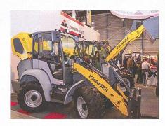
Arbeitseinsatz des Radladers wird die Leistung vom entsprechenden Motor bezogen. Eine Akkuladung reicht für einen Arbeitseinsatz von bis zu fünf Stunden. Die Ladezeit nimmt drei bis sechs Stunden in Anspruch. Die Energie wird in Blei-Säure-Akkus gespeichert.
