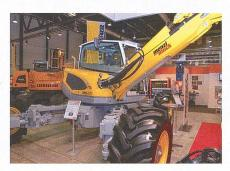
ein schnelles und harmonisches Zusammenspiel zwischen Motor und Hydraulik. Der «M2» verfügt über eine fein abgestimmte Load-Sensing-Hydraulik.
