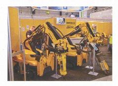
Der Roboter wiegt weniger als eine Tonne und kann daher auch auf Böden mit geringer Belastbarkeit eingesetzt werden. Die Motorleistung beträgt maximal 16,5 kW, das Hydrauliksystem hat ein Volumen von 45 Liter. Empfohlen sind Arbeitsgeräte bis 160 kg.
