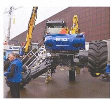
(150 PS) starker Perkins-Dieselmotor mit integriertem Partikelfilter. Für die beeindruckende Leistungsbilanz ist die Kaisertronic in Verbindung mit «ELIS» (Electonic Load Independent System) verantwortlich. Jeweils ein Hydraulikkreislauf bedient die Arbeits-, Fahr- und Lüfterpumpe. Die Fahrgeschwindigkeit ist stufenlos zwischen 0 und 15 km/h regulierbar.
