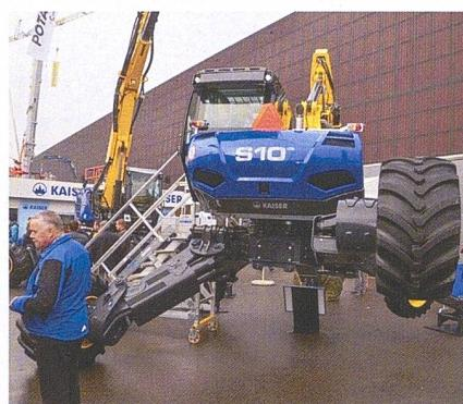
(150 PS) starker Perkins-Dieselmotor mit integriertem Partikelfilter. Für die beeindruckende Leistungsbilanz ist die Kaisertronic in Verbindung mit «ELIS» (Electronic Load Independent System) verantwortlich. Jeweils ein Hydraulikkreislauf bedient die Arbeits-, Fahr- und Lüfterpumpe. Die Fahrgeschwindigkeit ist stufenlos zwischen 0 und 15 km/h regulierbar.
