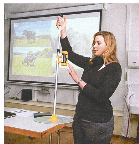
Mit diesem Sensor wird die Wuchshöhe von Gras gemessen und via GPS auf einer Karte lokalisiert, sodass das Weide- und Düngemanagement bedarfsgerechter erfolgen können.
