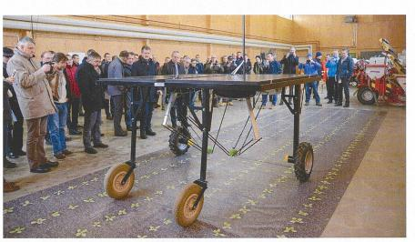
Gezeigt, wenn auch nur indoor und quasi unter Laborbedingungen, wurde der erste vollständig autonome Roboter für den gezielten Herbizideinsatz der Schweizer Firma Ecorobotix.
