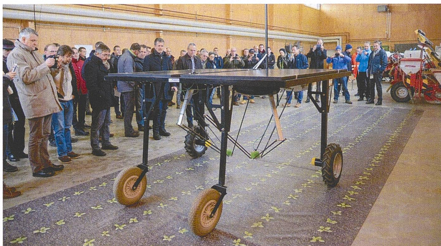
Gezeigt, wenn auch nur indoor und quasi unter Laborbedingungen, wurde der erste vollständig autonome Roboter für den gezielten Herbizideinsatz der Schweizer Firma Ecorobotix.
