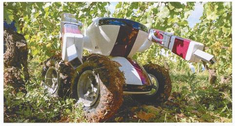
Roboter für den Rebschnitt künden sich an, doch müssen Leistungsfähigkeit und Zuverlässigkeit noch verbessert werden. Bild: France Info
