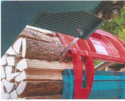
Die Bandsäge franst das Holz nicht aus, produziert keine Späne...
