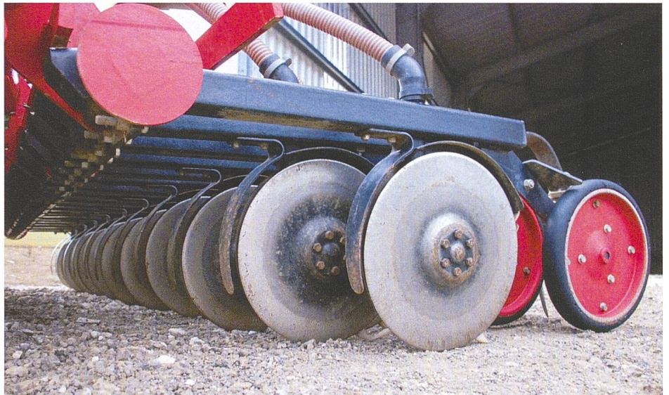
Druckrollen führen die Schar in der Tiefe und sorgen für den Bodenschluss.
