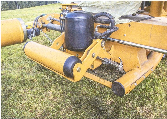
Ein schräg angeordneter Zylinder drückt den Ballenaufsteller nach oben.
