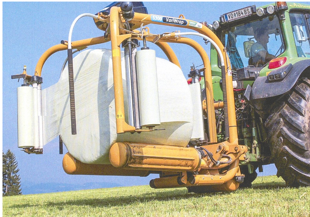
Dreipunktwickler wie Tanco «VariWrap S300» sind gerade im Alpenraum gefragt.
