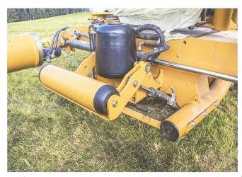
Ein schräg angeordneter Zylinder drückt den Ballenaufsteller nach oben.
