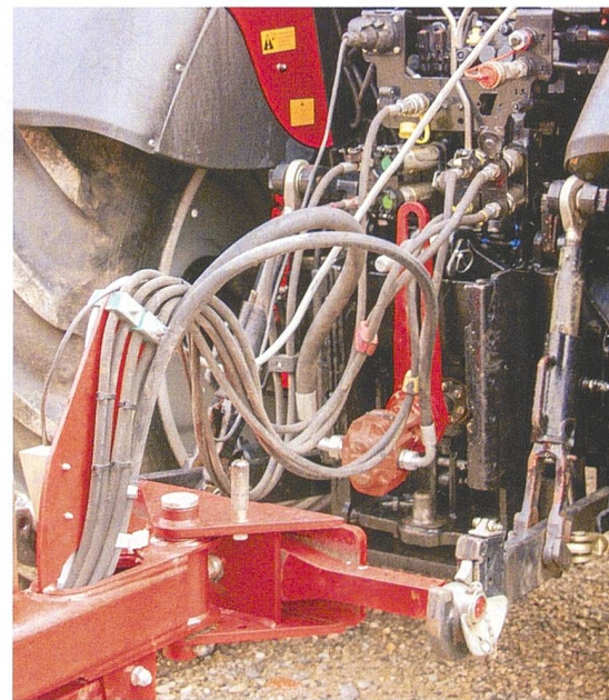
Die Maschine wird über eine Querstrebe an den Unterlenkern des Hubwerks angehängt.
