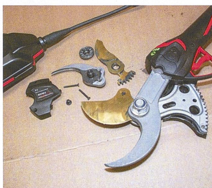
Einige Minuten reichen, um den Schneidkopf zu wechseln. Hier ist das «Maxi»-Kit auf der Astschere installiert.
