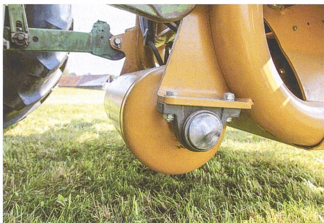
Mit der Stützrolle kann der Wickelvorgang auch am Boden durchgeführt werden.
