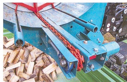
Hydraulisch angetriebene Vorschubeinheit zur stufenlosen Schnittlängeneinstellung bis 50 cm.
