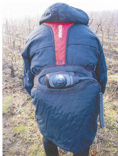
Der Akku wird entweder in einer anpassbaren Jacke am Gürtel getragen, direkt am Hosengürtel oder in einer Jackentasche.
