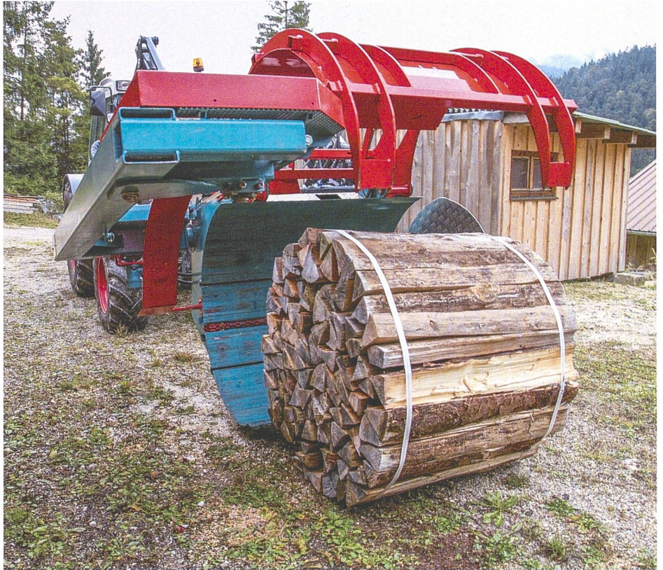
Standardbündel lassen sich ohne Absteigen mit dem Greifer aufnehmen.
