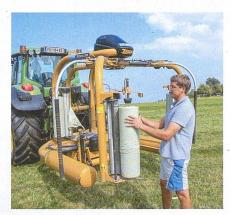
In wenigen Minuten wechselt der Fahrer die Folienrollen aus.
