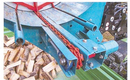
Hydraulisch angetriebene Vorschubeinheit zur stufenlosen Schnittlängeneinstellung bis 50 cm.
