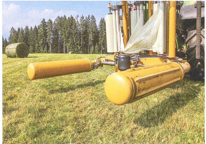
Die Wickelwalzen schöpfen ihre Kraft aus zwei separaten Ölmotoren.
