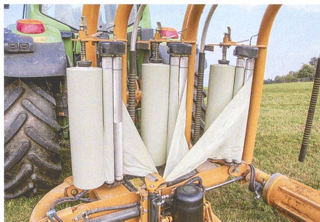
Die drei Arme des Tanco «VariWrap S300» klappen nach jedem Wickelvorgang zusammen.
