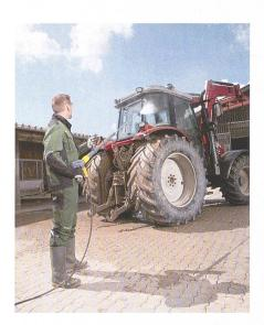
Solarmodulen. Bei der neuen Pistole «EasyForce» ist der Auslösemechanismus für den Hochdruckstrahl auf die Rückseite des Griffs verlegt worden. Der Abzug wird mit dem Handballen in den Griff geschoben – dadurch erübrigt sich nach dem Auslösen praktisch jegliche weitere Haltearbeit: Der Rückstoss des Wasserstrahls drückt den Abzug von selbst in die Hand.
