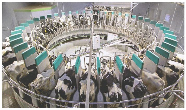
Beim vollautomatischen Melkkarussell «DairyProQ» ist jeder Melkplatz mit einem kompletten Melkmodul ausgestattet. Bild: GEA
