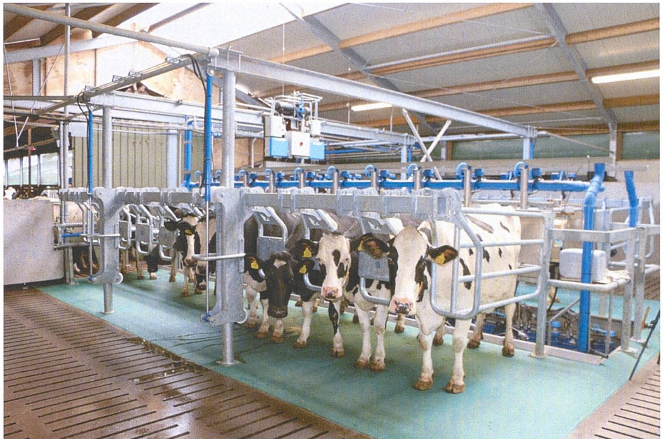
«Side-by-Side»-Anordnung mit Schnellaustrieb «Quick-E» von Lemmer-Fullwood. Die Melkstandgatter werden senkrecht angehoben. Bild: Lemmer-Fullwood
