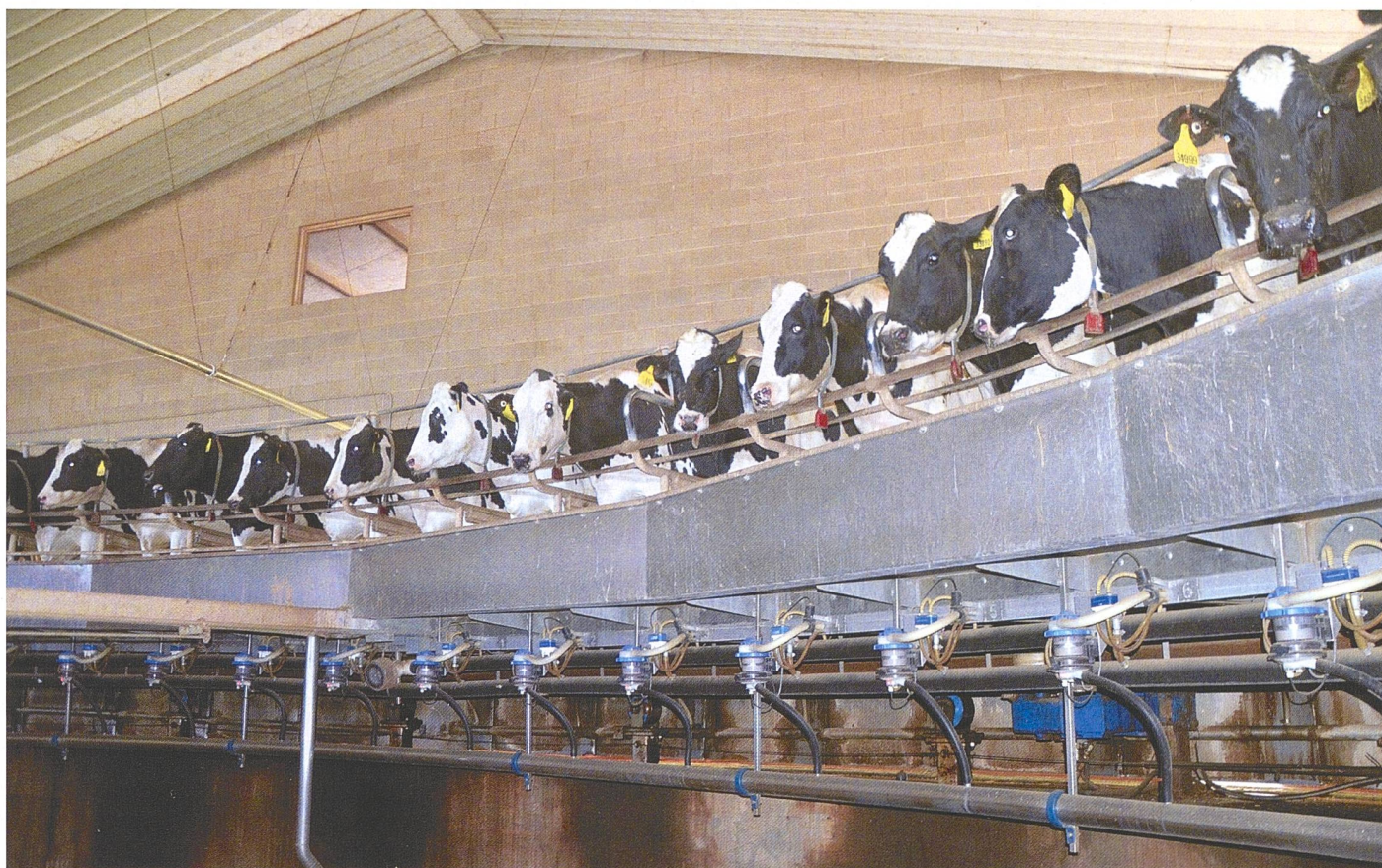
Ein Aussenmelker-Karussell bietet die grösste Anzahl Plätze und eignet sich für Bestände mit mehreren Hundert Milchkühen. Bild: R. Hunger
