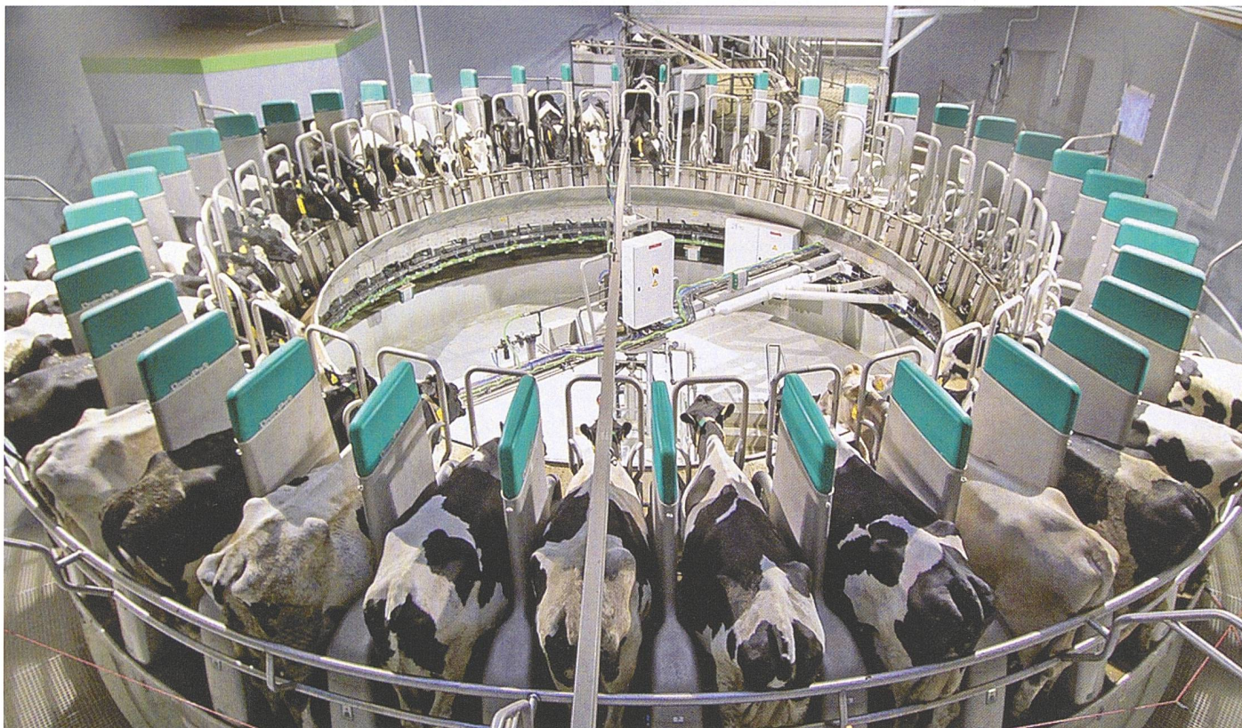
Beim vollautomatischen Melkkarussell «DairyProQ» ist jeder Melkplatz mit einem kompletten Melkmodul ausgestattet. Bild: GEA
