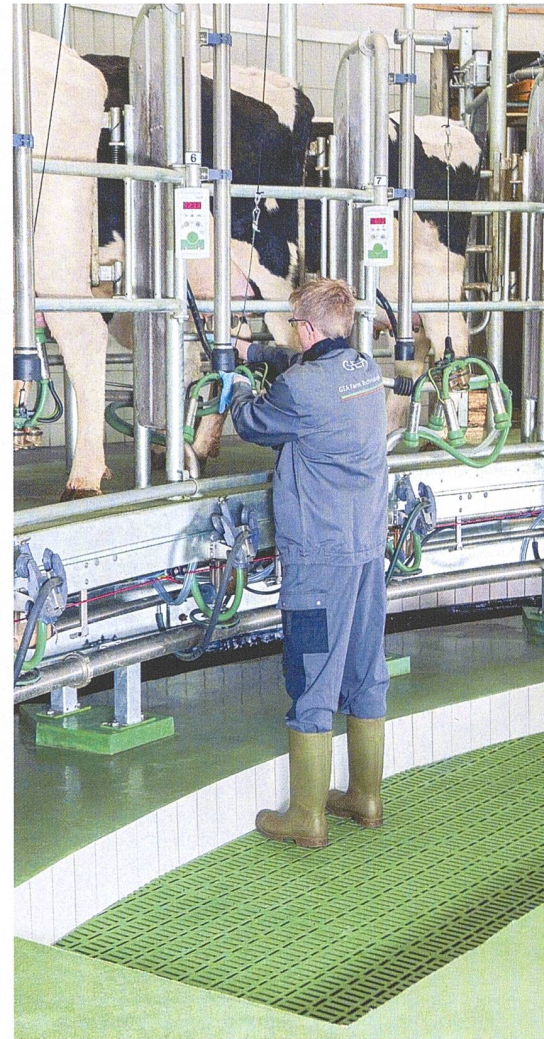
Mit einem Hubboden kann die Arbeitshöhe für die Melkperson optimal eingestellt werden. Bild: GEA
