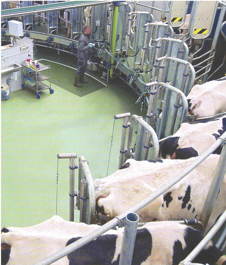
Melkkarussell mit Innenmelker, der Hubboden ist im Hauptarbeitsbereich des Melkers platziert. Bild: GEA
