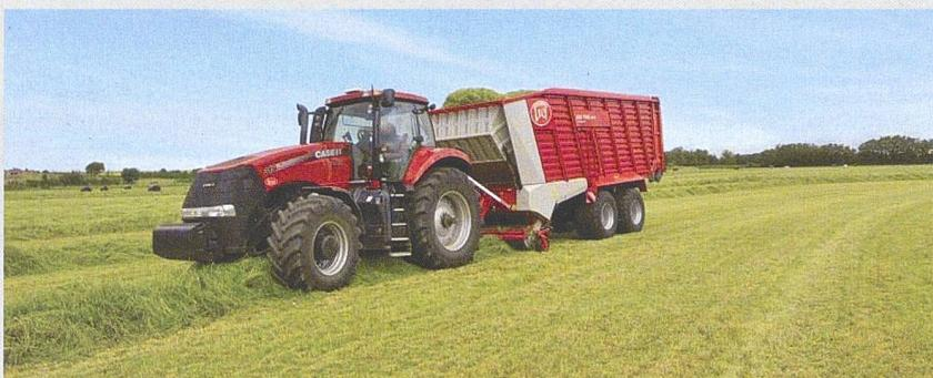
Lely bestückt die Pickups bei den Ladewagen «Tigo XR» mit verschleissfesten Kunststoff-Führungsbahnen. Dank der guten Gleiteigenschaften soll das Mähgut mit weniger Widerstand und so schonender zum Rotor geleitet werden. Weiter gibt es für diesen Wagen – wenn auch nur optional – eine Steuerung der Deichselhöhe. Ein Sensor misst ständig den aktuellen Stand und die Position der Aufnahme und steuert gleichzeitig den Hydraulik-
