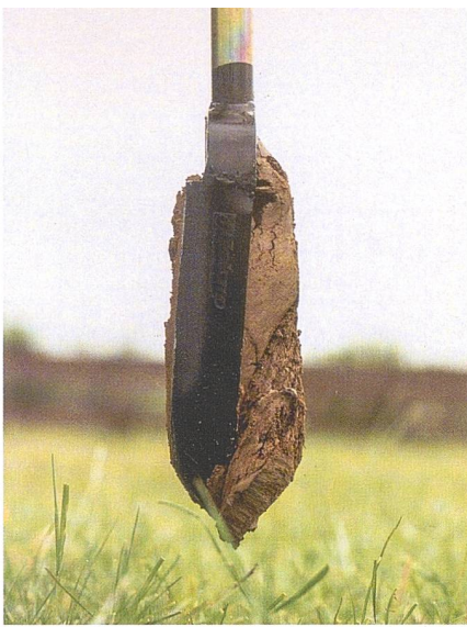
Zweckmässig für Probeentnahmen: der holländische Erdbohrer. Bild: SDEC Frankreich
