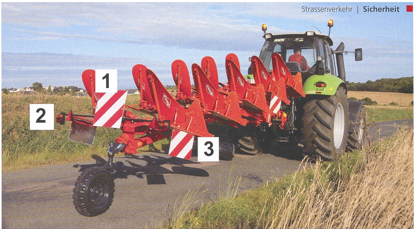
Dieser Pflug gilt als ein Arbeitsanhänger. Erforderlich sind daher Signalisationstafel rückwärts (1), Blink-/Lichtanlage und rote Dreieckrückstrahler (2) sowie Signalisationstafel(n) seitlich (links und rechts, 3). Hier fehlt die dreieckige Heckmarkierungstafel. Bild: Kuhn, Bearbeitung R. Hunger
