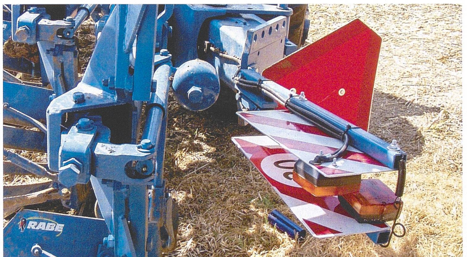
Wohin mit der Beleuchtungs-/Markierungsanlage? Wenn auch mit zusätzlichem Aufwand verbunden, ist es in den meisten Fällen sinnvoll, die Anlage am Ackerrand zu deponieren und vor der Heimfahrt wieder zu montieren. Bild: R. Hunger
