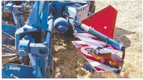
Wohin mit der Beleuchtungs-/Markierungsanlage? Wenn auch mit zusätzlichem Aufwand verbunden, ist es in den meisten Fällen sinnvoll, die Anlage am Ackerrand zu deponieren und vor der Heimfahrt wieder zu montieren. Bild: R. Hunger
