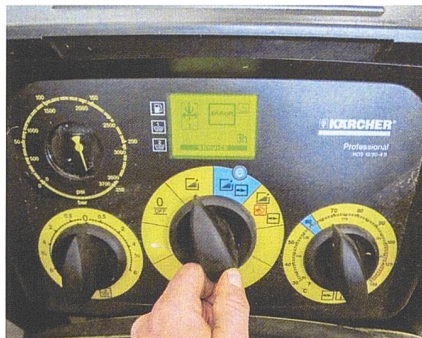
Das Bedienpanel mit LCD-Display, Füllstandsanzeigen und drei Drehschaltern.
