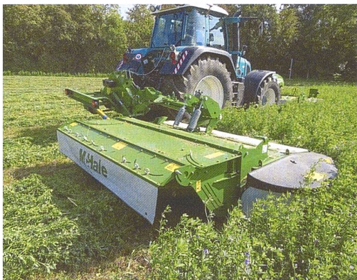
Dreidimensionale Bodenadaptation mit Vor- und Rückwärtsbewegungen sind Merkmale der Heckeinheit.
