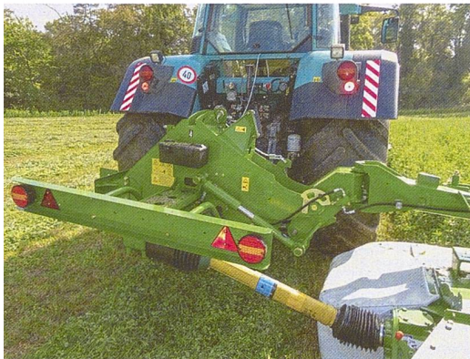
Das Heckmähwerk «R3100» ist 1470 kg schwer und ausgestattet mit massivem Lichtbalken und Blinklichtanlage.
