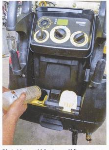
Die beiden unabhängig anwählbaren Zusatzmitteltanks fassen 10 und 20 Liter.
