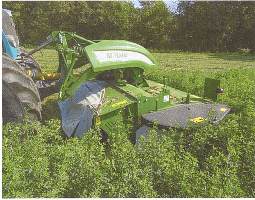
Das Frontmähwerk hat eine eigene Federentlastung und kann bis zu 500mm unabhängig vom Traktor dem Bodenprofil folgen.
