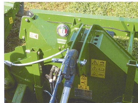
Ein Manometer zeigt den jeweils eingestellten hydraulischen Vorspanndruck der Entlastung an.
