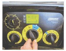
Das Bedienpanel mit LCD-Display, Füllstandsanzeigen und drei Drehschaltern.
