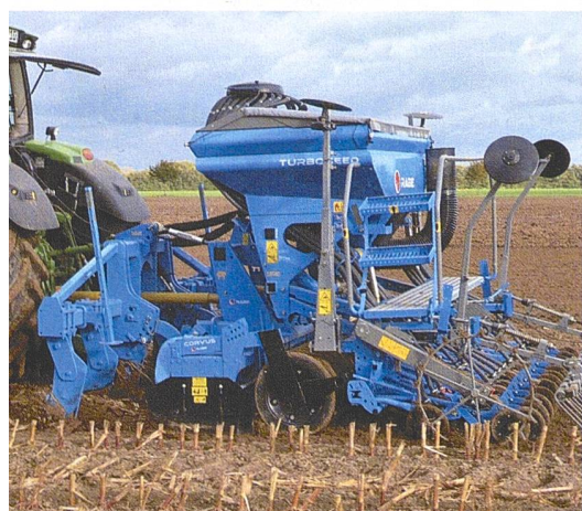
Eine kompakte Bauweise lässt auch eine Kombination von passiver und aktiver Bodenbearbeitung zu. Bild: Rabe
