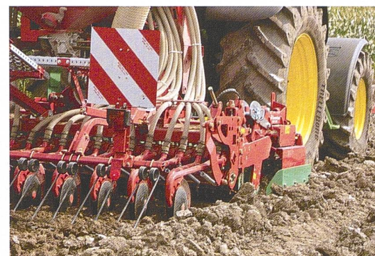
Zapfwellenbetriebene Geräte bauen kurz und eignen sich deshalb gut zur Kombination mit Sätechnik.
