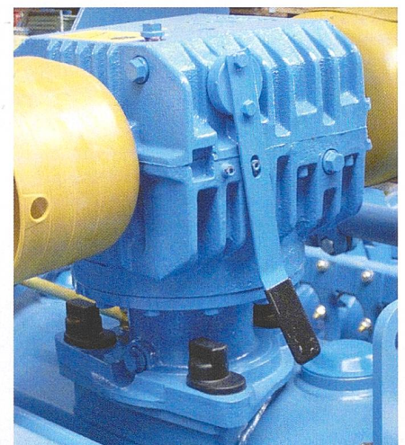
Eine einfache Getriebebeschaltung stellt sicher, dass unterschiedliche Drehzahlen auch genutzt werden.
