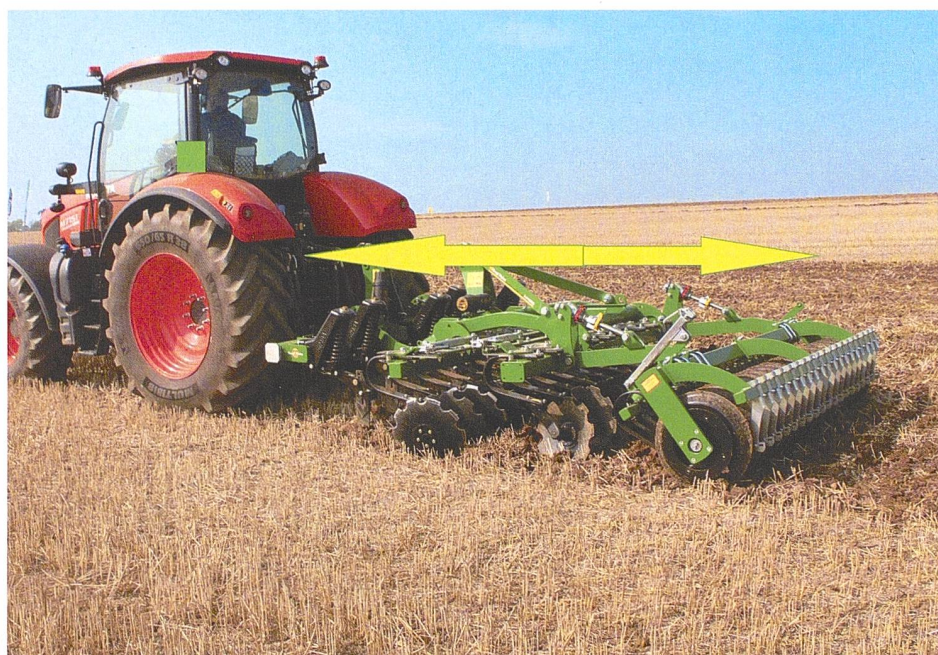
Je länger das Gerät, desto stärker wirkt sich das Gewicht des Anbaupackers auf die Hydraulik-Hubkraft aus. Bild: Great Plains
