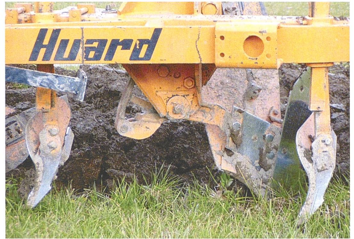
Der «Halbautomat» ist ein Überlastsystem, das zwischen Scherschraube und NonStop platziert ist. Bild: R. Hunger
