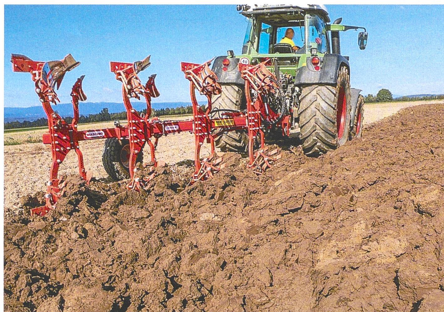
Je nach Bodenart können Streifenkörper Vorteile bieten. Bild: Aebi Suisse
