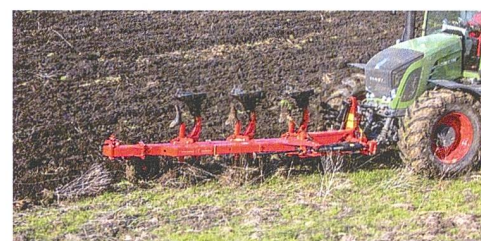
Die Variante «Frontpflug» hat vor allem in Frankreich und in einigen nordischen Ländern eine gewisse Bedeutung. Bild: Grégoire-Besson
