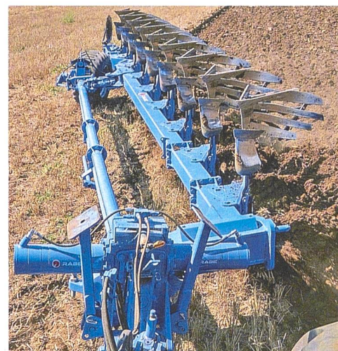
Aufsattelpflüge sind für Grossbetriebe eine echte Alternative zu Anbaupflügen. Bild: Rabe
