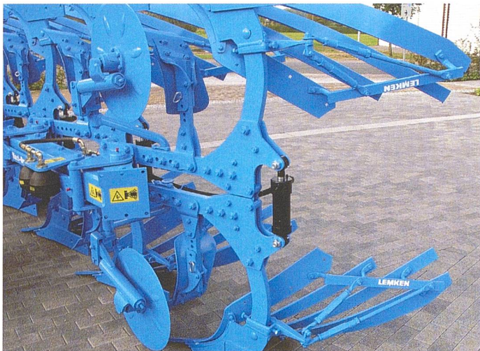
Sowohl mechanische wie hydraulische «NonStop»-Systeme ermöglichen ein unterbrechungsfreies Arbeiten. Bild: R. Hunger
