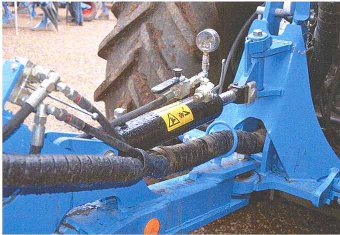
Traktionsverstärker übertragen zusätzliches Gewicht vom Aufsattelpflug auf die Traktorhinterachse. Bild: R. Hunger
