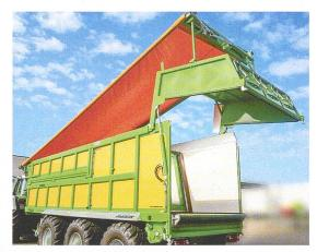
schiebung der Achse von links nach rechts und umgekehrt beim Schliessen. Das wasserdichte System erlaubt es, die Heckklappe zu öffnen, auch wenn die Plane geschlossen ist.
