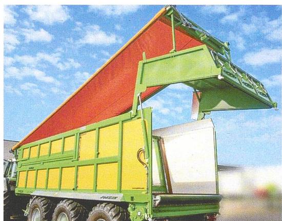
schiebung der Achse von links nach rechts und umgekehrt beim Schliessen. Das wassererdichte System erlaubt es, die Heckklappe zu öffnen, auch wenn die Plane geschlossen ist.
