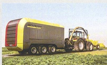
ten Phase lassen sich je nach Bedarf auch Additive in das Material einmischen. Im folgenden Verdichter wird das Material dann zu fertigen Pellets gepresst. Ein Sieb sondert den entstandenen Staub von den fertigen Pellets ab. Bunker und Ausladeband dienen dem Lagern und Kühlen der gebrauchsfertigen Pellets.
