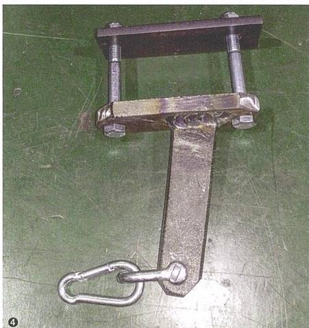
**1 Verbindungseinrichtungen nach UNECE-R 55 müssen mit einer Öse für die Befestigung der Anhängerabreissleine ausgerüstet sein.**
