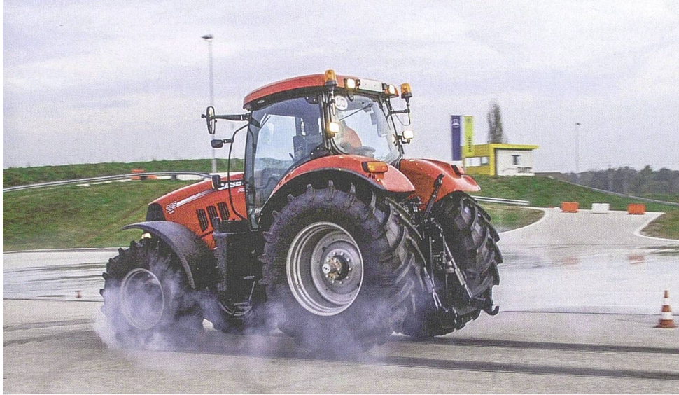
Das Antiblockiersystem ABS wirkt einem Blockieren der Räder entgegen und verhindert so das Ausscheren und Abdriften. Bild: R. Engeler
