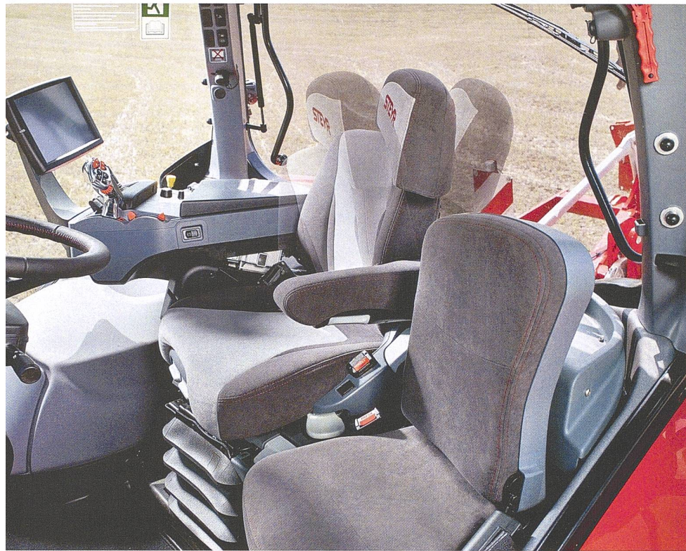
Ein Fahrersitz mit «Dualmotion»-Funktion und Drehmechanik reduziert die Ermüdungserscheinungen merklich. Bild: Steyr
