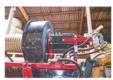
Der leerlaufende Elektromotor dient bloss als Lager zwischen Absauggebläse und Hydraulikmotor.
