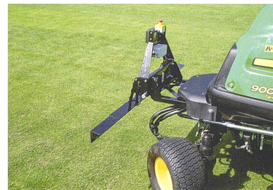
Die «Stossstangen» sind mit Radar- und Ultraschallsensoren ausgestattet, sodass der Mäher das Umfeld erkennt und entsprechend reagieren kann (ausweichen oder stoppen).
