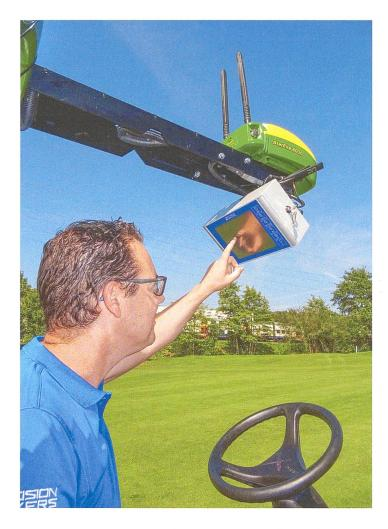
Wichtigste Elemente für das autonome Fahren: GPS-Empfänger und die Steuerungselektronik.
