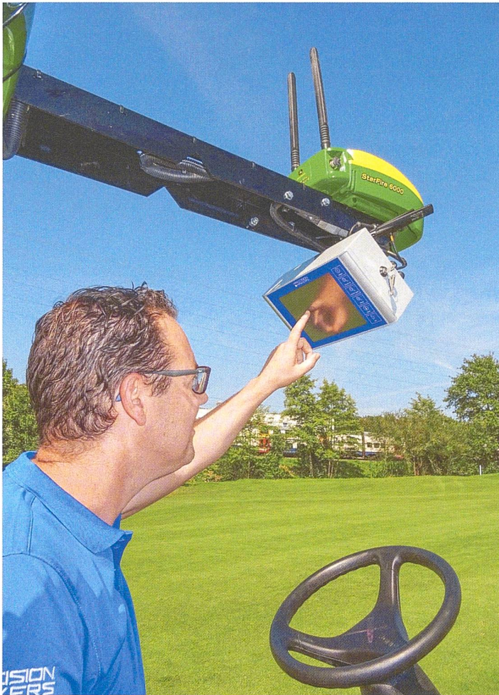
Wichtigste Elemente für das autonome Fahren: GPS-Empfänger und die Steuerungselektronik.
