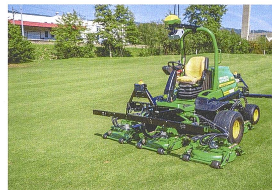
Autonom und ohne Fahrer auf dem Green und Fairway unterwegs: ein Rasenmäher John Deere «9009».
