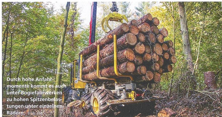
Die möglichst gleichmässige Lastenverteilung auf alle Räder ist ein wichtiges Kriterium für den Erhalt der Befahrbarkeit der Rückegassen im Wald. Bei Sechs- und Achtradforstmaschinen sind jeweils das rechte und linke Radpaar pendelnd am Fahrzeugrahmen gelagert. Daraus ergibt sich eine gute Geländegängigkeit beim Überfahren von Hindernissen oder Gräben.
