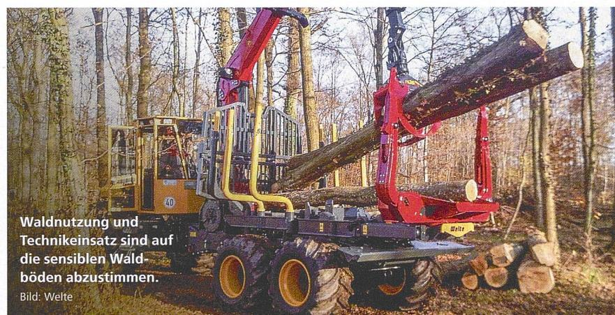
Die Analysen der Bodendichten zeigen unter anderem, dass sich die Bodenlagerungsdichte bei Stop-and-go-Überfahrten ohne Radlastregelung um rund 22 % erhöhte. Das gleiche Vorgehen mit Radlastregelung reduzierte die Bodenverdichtung um über 50 % gegenüber den konventionellen Überfahrten. Gleichzeitig erhöht sich mit der Radlastregelung die Traktion der Maschine. ■
