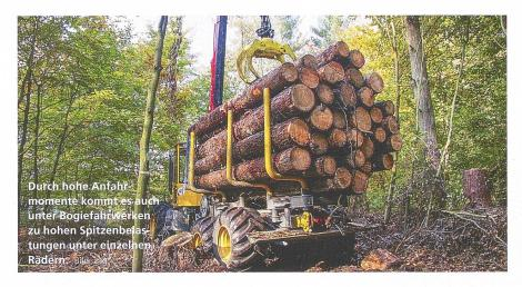
Die möglichst gleichmässige Lastenverteilung auf alle Räder ist ein wichtiges Kriterium für den Erhalt der Befahrbarkeit der Rückegassen im Wald. Bei Sechs- und Achtradforstmaschinen sind jeweils das rechte und linke Radpaar pendelnd am Fahrzeugrahmen gelagert. Daraus ergibt sich eine gute Geländegängigkeit beim Überfahren von Hindernissen oder Gräben.
