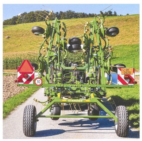
Über 2,10 m breite oder über 7 m lange Arbeitsanhänger müssen bei Strassenfahrten mit Markierlichtern ausgerüstet sein. Bilden BUL
