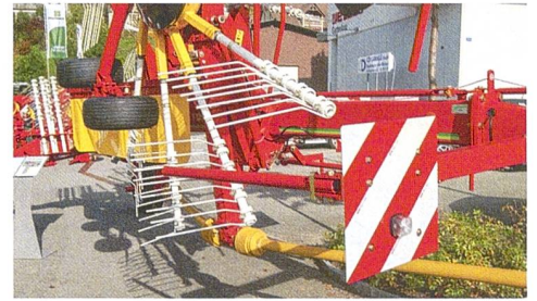
Bei über 2,10m breiten Arbeitsanhängern sind zwei von vorne (weisse) und zwei von hinten (rote) sichtbare Markierlichter erforderlich.
