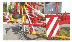
Bei über 2,10 m breiten Arbeitsanhängern sind zwei von vorne (weisse) und zwei von hinten (rote) sichtbare Markierlichter erforderlich.
