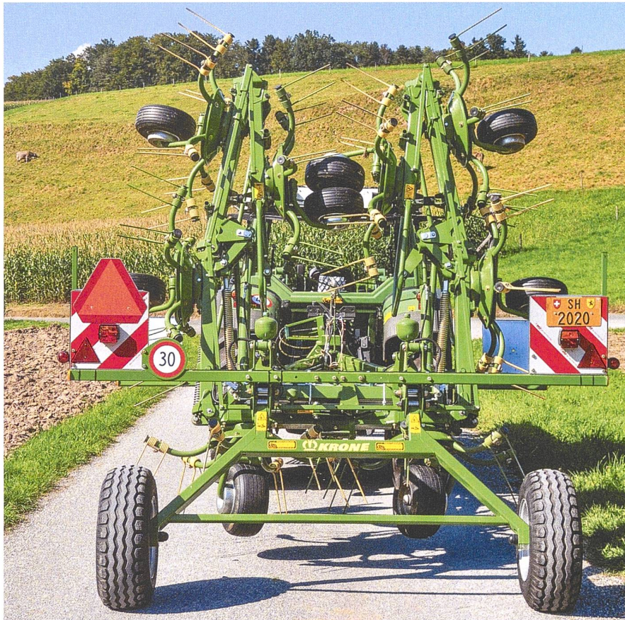
Über 2,10m breite oder über 7m lange Arbeitsanhänger müssen bei Strassenfahrten mit Markierlichtern ausgerüstet sein. Bilder: BUL
