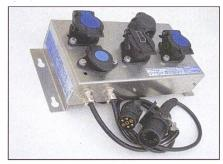
«All in one», der Spannungswandler für das «ABS»/«EBS»-System und für die Beleuchtungseinrichtung am Anhänger. Das Wechseln der Glühbirnen am Anhänger erübrigt sich. Wird ein Anhänger von mehreren Traktoren gezogen oder überbetrieblich eingesetzt, macht es Sinn, entweder den Spannungswandler auf dem Anhänger zu montieren oder mit einer mobilen Box zu arbeiten.
