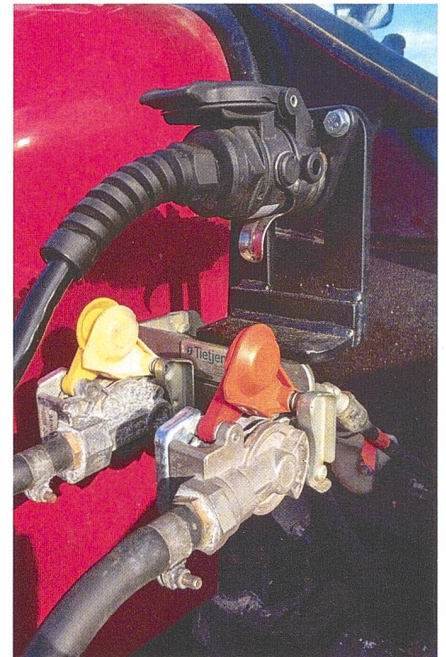
Eine «ABS»-Steckverbindung am Traktor.
