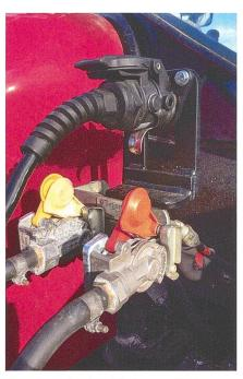
Eine «ABS»-Steckverbindung am Traktor.
