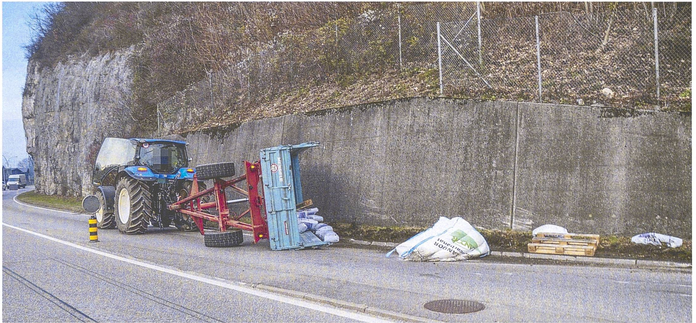
Eine optimale Ladebrücke genügt für die Ladungssicherung noch nicht; dem Rutschverhalten ist ebenfalls Rechnung zu tragen, damit so etwas nicht passiert. Bild: Kapo
