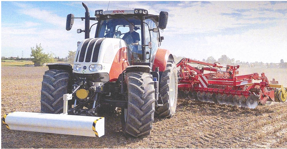
Zur gleichzeitigen Bestellung des Bodens gibt das Gerät die Daten an die Bearbeitungsmaschine weiter, sodass eine effiziente Tiefensteuerung möglich wird. Bilder: Geoprospectors GmbH
