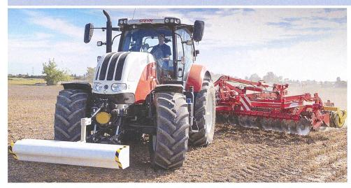
Zur gleichzeitigen Bestellung des Bodens gibt das Gerät die Daten an die Bearbeitungsmaschine weiter, sodass eine effiziente Tiefensteuerung möglich wird. Bilder: Geoprospectors GmbH
