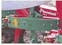
Bei hydraulischen Systemen lässt sich das Auslösemoment durch Druckänderungen anpassen. Mechanische Systeme können durch Änderungen der Federvorspannung oder mit zusätzlichen Blattfedern erhöht oder reduziert werden. Änderungen von Druck oder Federvorspannung dürfen nur in Übereinstimmung mit der Betriebsanleitung vorgenommen werden.
