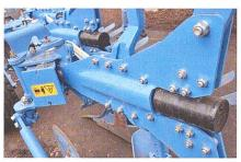
Pflugspitze-Schar auf einen Widerstand, der grösser ist als die Haltekraft der Überlastsicherung, weicht der Pflugkörper zurück. Die gleichzeitig wachsende Rückstellkraft lässt den Pflugkörper bei nachlassendem Widerstand in die Arbeitsposition zurückkehren.
