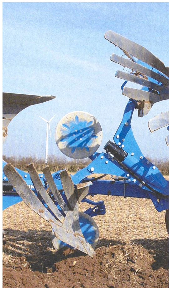
Stein- oder Überlastsicherungen sollen den Pflug vor grösserem Schaden schützen.
