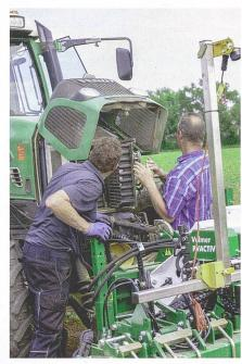
An laufenden Maschinen dürfen niemals Störungen behoben werden. Bild: Landpixel.de
