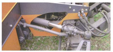
Reparaturen an der Lenkung oder Vorderachsaufhängung sind teuer, und ein Augenmerk bei der Beurteilung ist daher angezeigt. Die amtliche Kontrolle gibt eine gute Gewähr, dass diese Bauteile in Ordnung sind.
