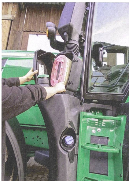
Praktisch: Die Luftfilterpatrone ist links vom Aufstieg montiert.
