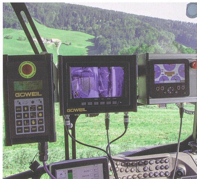
Das Bedienungsterminal ist klein, aber zweckmässig. Die Triebachse ist mit einer separaten Steuerungseinheit ausgerüstet; ein Farbbildschirm bietet einen guten Überblick über den Betriebszustand.
