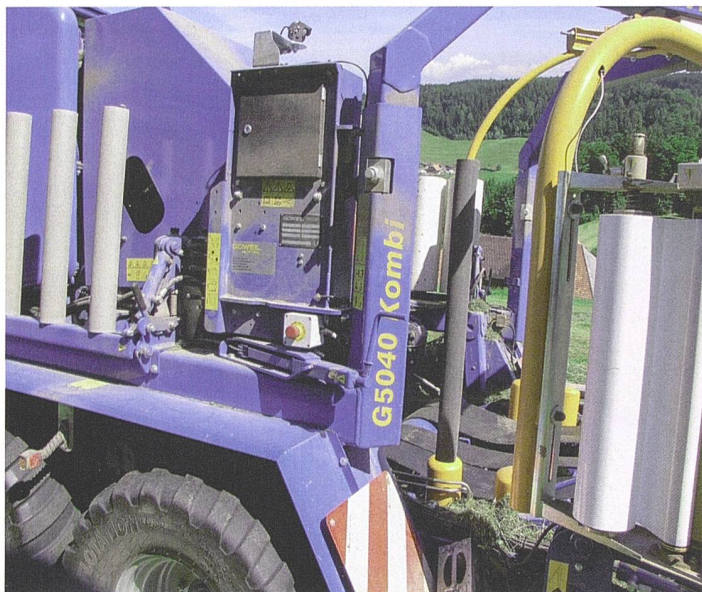
Sämtliche Funktionen können für Arbeiten an der Maschine oder bei einem Ausfall der Elektronik auch manuell an den Steuerblöcken hinten bedient werden.
