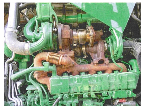
Der Power-Tech-Motor (PPS) mit 6,8-l-Hubraum, Reihenturbolader leistet mit IMP satte 300 PS.
