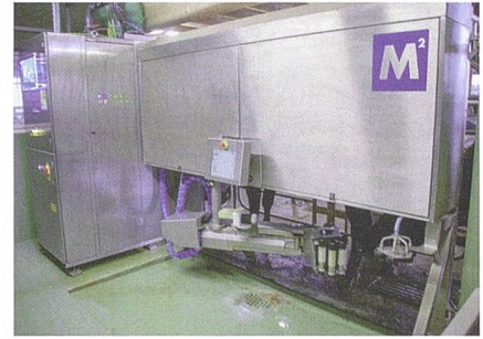
Herzstück der Automatisierung im Stall von Alois und Anita Moos ist «Merlin». Der Melkroboter arbeitet dank Elektromotoren äusserst leise.
