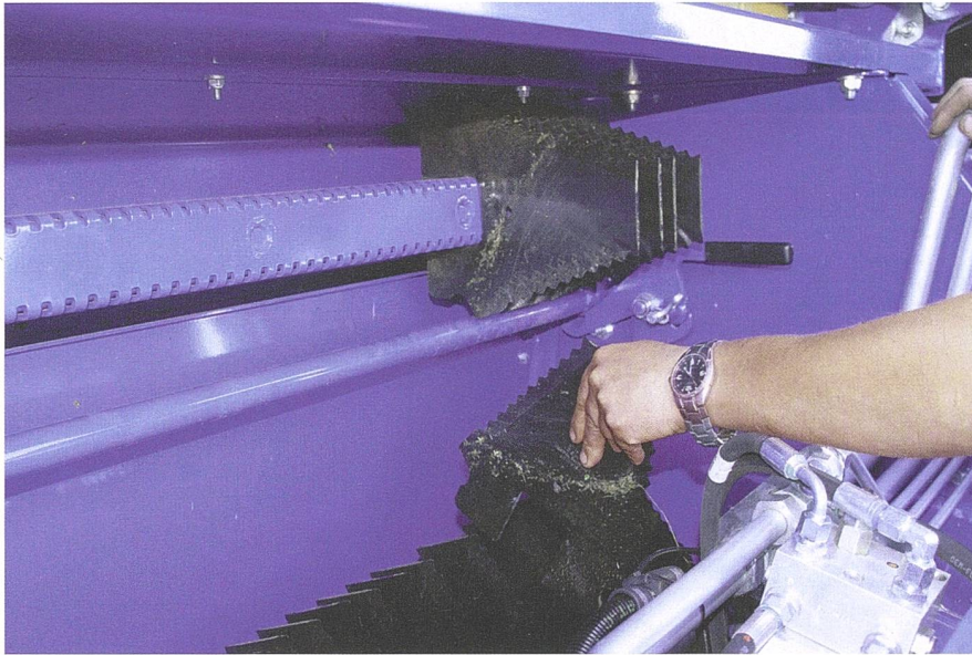
Der Messerwechsel kann über dem Rotor in einer sehr bequemen Position vorgenommen werden. Bild: Johannes Paar
