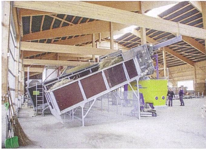
In der Futterküche sorgen vier Vorratsbehälter dafür, dass der Fütterungsroboter jederzeit mit den nötigen Futterkomponenten befüllt wird.
