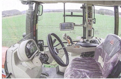
Der multifunktionale Fahrhebel und der zusätzliche Joystick sind die zentralen Bedienelemente auf der Armlehne.
