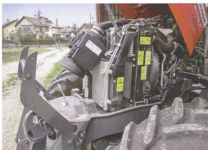
Die Kühler sind für die Reinigung mit grossem Abstand versehen und müssen deshalb nicht aufgeklappt werden.
