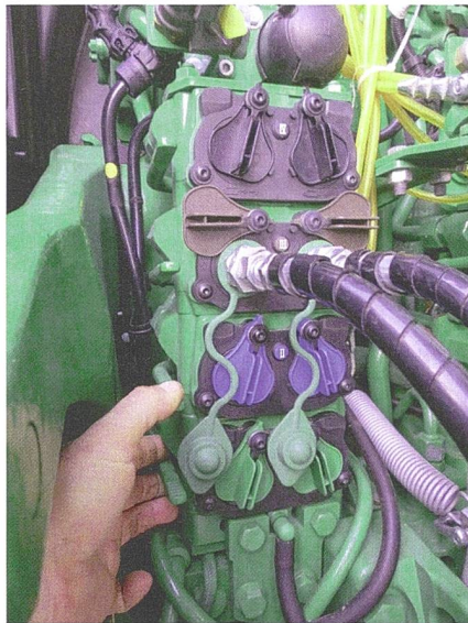
Maximal gibt es sechs Steuerventile im Heck mit praktischem Lösehebel, maximal drei an der Front.
