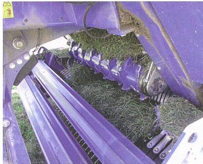
Die profilierte Vorpresswalze beschleunigt das Futter zwischen Pick-up und Rotor.
