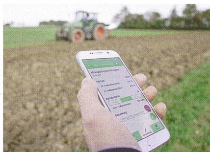
Beacons auf Maschinen korrespondieren mit einer kompatiblen App auf dem Smartphone und übertragen die Daten zur Weiterverarbeitung. Bild: Farmdock
