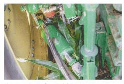
Eine Gemeinschaftsentwicklung von Monosem und John Deere ermöglicht die präzise Führung von Reihenhackgeräten durch Unterlenkersteuerung.
