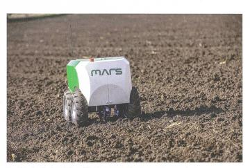
Landtechnik der Zukunft? Lange wurde davon gesprochen nun beginnt die Umsetzung. Das Bild zeigt einen Feldroboter aus dem «Mars»-Forschungsprojekt von Fendt.
