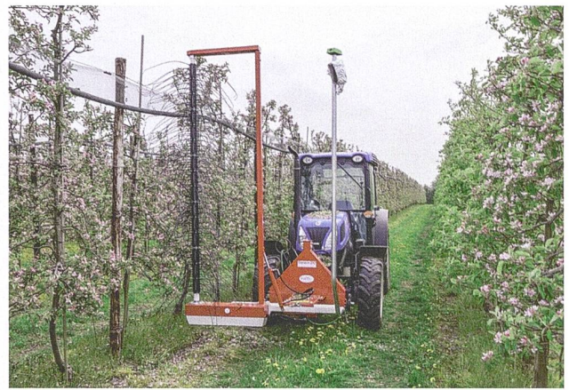
Mit dem «Darwin SmaArt»-Kamerasystem von Fruit-Tec Adolf Betz kann die Blüten- bzw. Fruchtausdünnung automatisiert werden.
