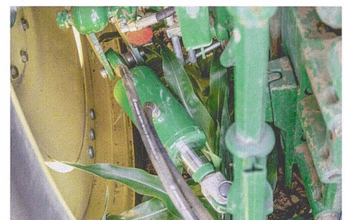
Eine Gemeinschaftsentwicklung von Monosem und John Deere ermöglicht die präzise Führung von Reihenhackgeräten durch Unterlenkersteuerung.
