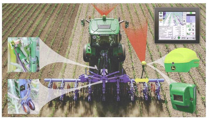
Die automatische Lenkung von Hackgeräten bekommt allein aufgrund der höheren Effizienz eine immer grössere Bedeutung. Bilder: zvg
