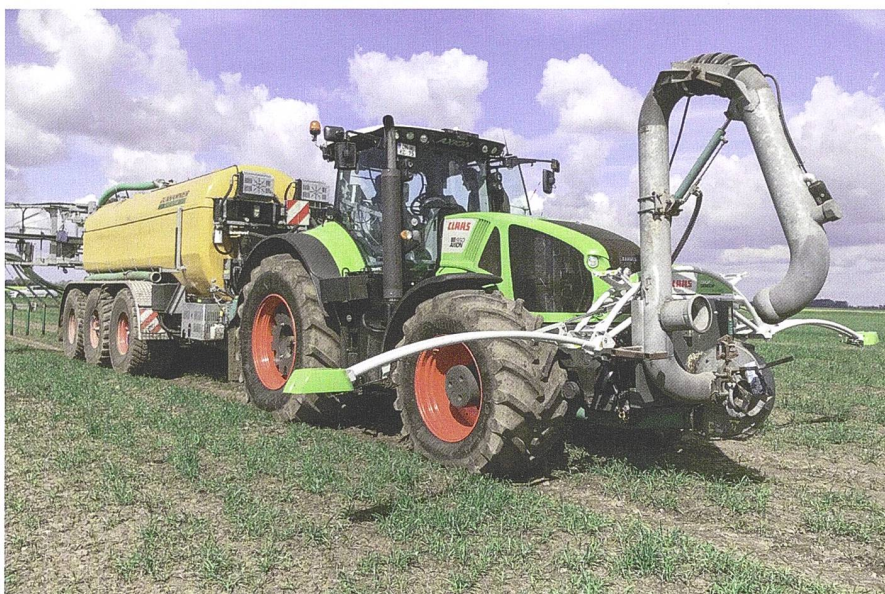
Dank zwei kombinierten Sensorsystemen kann Gülle heute auch teilflächenspezifisch ausgebracht werden. Bild: Zunhammer
