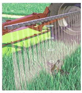
Dank Sensorbalken und blitzschnell reagierenden Hydrauliksystems haben Rehkitze auch eine Überlebenschance. Bild: Pöttinger
