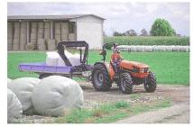
Die «Argon»-Modelle sind bei Same die Einstiegsmodelle für den Einsatz bei leichten Feld- und Hofarbeiten. Die erneuerte Baureihe umfasst insgesamt sechs Modelle, zwei mit Hinterradantrieb und vier mit Allradantrieb, mit einer Leistung von 65 bis 97 PS. Auffallend ist das markante Design mit neuer einteiliger Motorhaube. Unter der Haube arbeiten 3-Zylinder-Motoren (Farmotion) mit Commonrail-Hochdruckeinspritzung von 2000 bar, Turbolader, Ladeluftkühler und
