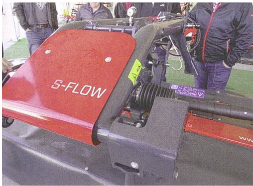
Der gezogene Anbaubock «S-Flow» für die Frontmäherwerke passt sich selbst bei schneller Fahrt den Bodenunebenheiten an.
