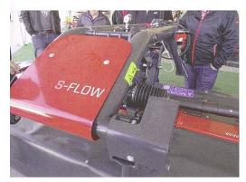
Der gezogene Anbaubock «S-Flow» für die Frontmähwerke passt sich selbst bei schneller Fahrt den Bodenunebenheiten an.
