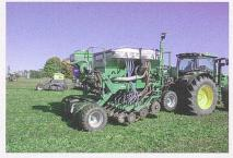
Reihenabstand und ein 3-Scheiben-System mit einem sogenannten Turbo-Coulter vor Doppelscheiben. Drei Tanks ermöglichen das gleichzeitige Einbringen von Saatgut, Dünger und Schneckenkörnern. Die gezogene Sämaschine ist radgeführt und wiegt 5000 kg. Die Tiefeneinstellung erfolgt zentral und an jedem Säelement. Der Scheibendruck beträgt 150 kg.
