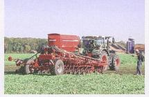
Die gezogene 6-m-Sämaschine «Avatar 616 SD» von Horsch ist sowohl für die konventionelle als auch für die Mulchund Direktsaat geeignet. Ausgerüstet ist sie mit
