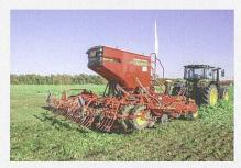
Auch die gezogene «Rapid A 400 S» von Väderstad kann sowohl für die konventionelle wie für die Mulchund Direktsaat eingesetzt werden. Möglich ist bei den 32 Einscheiben-
