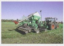
Die 4m breite «NTA 1300» von Great Plains ist eine gezogene 24-Reihen-Universalsämaschine, die auf dem Betrieb der Strafanstalten in Bellechasse eingesetzt wird. Ausge-
