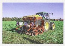
Diese 3-Punkt-Einscheibenschar-Sämaschine von Maschio Gaspardo mit 3 m Arbeitsbreite und mit mechanischem Federsystem hat 17 Einscheibenschare und gehört der
