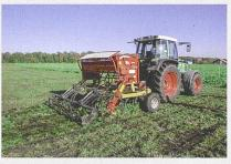
Die Sämaschine ist 3 m breit, hat zwölf Zinken-Säscharen. Der Zugkraftbedarf für das gerade mal 1250 kg schwere Gerät beträgt rund 90 PS. Die Saattiefeneinstellung erfolgt mit Rädern vor dem Rahmen sowie der Rohrpackerwalze hinter dem Rahmen. Die Sämaschine ist rahmengeführt. Martin Häberli hat mit seiner «Seeder» schon unzählige Hektaren gesät.
