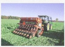
breite von 2,4 m und 15 Doppelscheibenscharen beträgt der Reihenbestand 16,5 cm. Das Gewicht ist mit 2300 kg äusserst gering. Ein 50-PS-Traktor reicht für den Einsatz gemäss Besitzer völlig aus. Die Saattiefeneinstellung ist mit jeder Schar einzeln möglich. Die Sämaschine ist schargeführt. Semeato ist ein Sämaschinen-Hersteller aus Brasilien.
