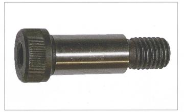
Bei formschlüssigen Verschraubungen werden Passschrauben verwendet, deren Schaft spielfrei in die präzise Bohrung passt. Diese Art der Verschraubung ist teuer und wird dort eingesetzt, wo die beiden zu verschraubenden Teile exakt zu positionieren sind.
