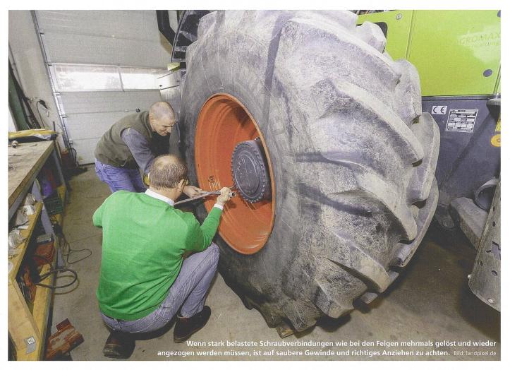
Verschraubungen können form- oder kraftschlüssig ausgeführt werden. Bei der formschlüssigen Variante werden sogenannte Passschrauben mit einer präzisen Bohrung spielfrei gepaart. Ein Verrutschen verschraubter Teile ist bei dieser Variante auch ohne grossen Anpressdruck und mit geringerem Anziehdrehmoment gewährleistet. Formschlüssige Verschraubungen sind wegen der nötigen Präzision aufwendig in der Produktion, werden daher nur in speziellen Fällen angewendet.
