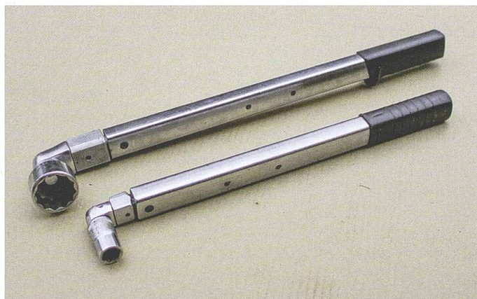
Das empfohlene Anziehdrehmoment kann nur mit einem Drehmomentschlüssel erzielt werden. Das Anziehen nach Gefühl ist bei wichtigen Schrauben zu ungenau. Schraubentabellen, die im Internet publiziert sind, enthalten unter anderem auch empfohlene Anziehdrehmomente.
