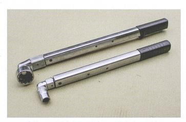
Das empfohlene Anziehdrehmoment kann nur mit einem Drehmomentschlüssel erzielt werden. Das Anziehen nach Gefühl ist bei wichtigen Schrauben zu ungenau. Schraubentabellen, die im Internet publiziert sind, enthalten unter anderem auch empfohlene Anziehdrehmomente.
