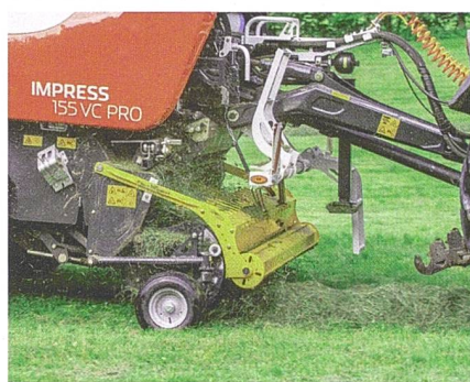
Der flach angelenkte Pendel-Pick-up nimmt das Futter selbst in stark kupiertem Gelände sauber auf.
