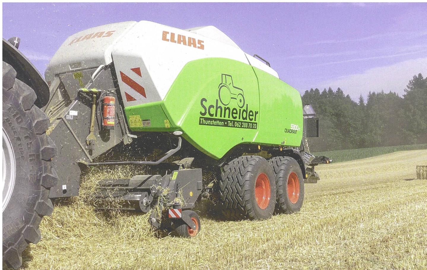
Hochleistungsknoter, automatische Pressdruckregelung und hydraulischer Einzug: Diese Features werden bei Claas mit der «Quadrant 5300» nun auch für das Ballenmass 120×90 cm verfügbar. Bilder: R. Engeler, M. Schneider
