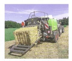
Der neue Presskanal hat eine durchgehende obere Pressklappe. Somit entfallen die oberen Winkelbleche, das Material wird über die ganze Breite gleichmässig geformt.
