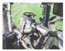
Der Sitz mit Armlehne und den beiden Bedieneinheiten des Roders können nach links und rechts abgedreht werden.
