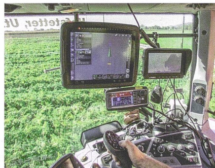
Das automatische Lenksystem wird über das grosse «C3000» Terminal mit Touchscreen angezeigt und bedient.
