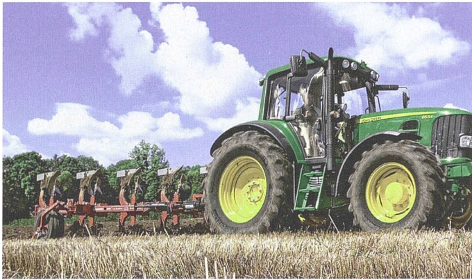
Im Einsatz mit Bodenbearbeitungsgeräten ist ein Gangwechsel ohne Kupplungsbetätigung und Zugkraftunterbrechung gefragt.
