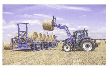
Effizientes Arbeiten mit dem Frontlader setzt voraus, dass die Fahrrichtungswechsel rasch erfolgen. Bild: New Holland
