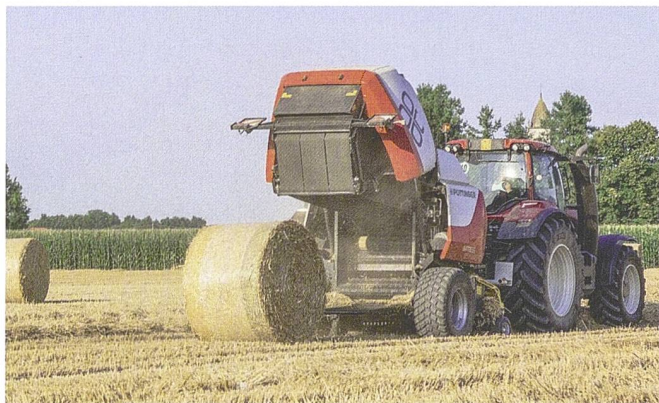
Leistungsfähige Ballenpressen stellen neue Anforderungen an Traktorgetriebe. Bild: Pöttinger
