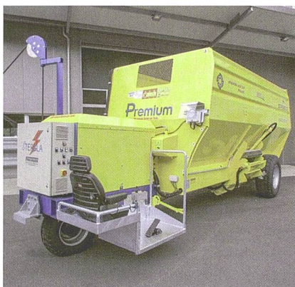
Der neu entwickelte Elektro-Fahrkopf für Futtermischwagen von Sgariboldi soll ab 2018 verfügbar sein.
