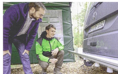
Der an einem Auto angebrachte Scanner erfasst den Zustand des Waldweges. Damit können Wegkartierungen und Sanierungspläne erstellt werden.
