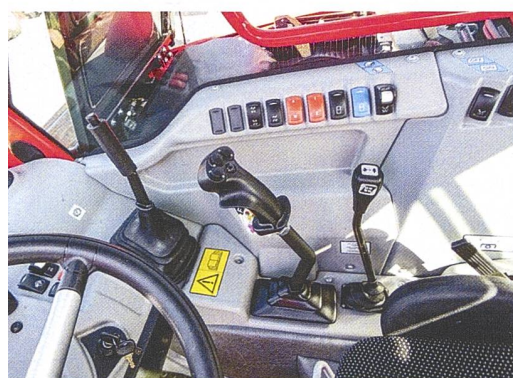
Die Bedienelemente sind in «logischen» Gruppen zusammengefasst mit dem Ziel, dem Fahrer die Sache einfacher und sicherer zu machen.
