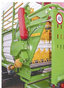
Links: Die Dosierwalze «HL-L5» gibt es neu mit drei Walzen und einem 75 cm breiten Förderband. Rechts: Für die Agrar-Gülle-fässer gibt es als Option einen Schleppschuhverteiler von Bomech.
