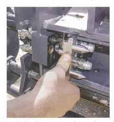
Der Verriegelungsvorgang: Die Kuppelstation des Anbaugerätes wird mit dem Verriegelungssystem am Lader «verbunden».
