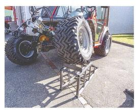
Bis zu 15° Achspendelung (bei langem Radstand) sind bei den neuen «Metrac»-Modellen möglich.
