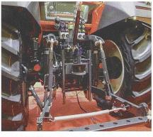
Die Lenkzylinder für die hinteren Räder sind nun vor der Achse platziert, was mehr Freiraum für das Heckhubwerk gibt.
