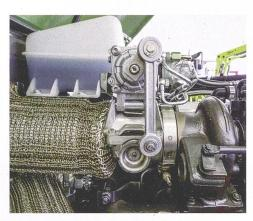
Die Stauklappe, typisch bei den Motoren von Fiat-Power-Train (FPT), wirkt auch als Motorbremse.
