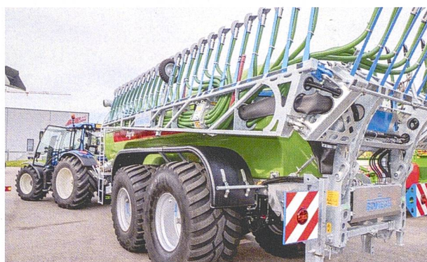
Links: Die Dosierwalze «HL-L5» gibt es neu mit drei Walzen und einem 75 cm breiten Förderband. Rechts: Für die Agrar-Gülle-fässer gibt es als Option einen Schleppschuhverteiler von Bomech.
