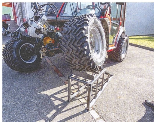
Bis zu 15° Achspendelung (bei langem Radstand) sind bei den neuen «Metrac»-Modellen möglich.
