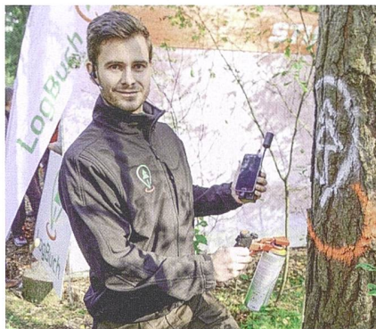
Das Modul am Farbspray erfasst via Mobiltelefon den genauen Standort des angezeichneten Baumes.
