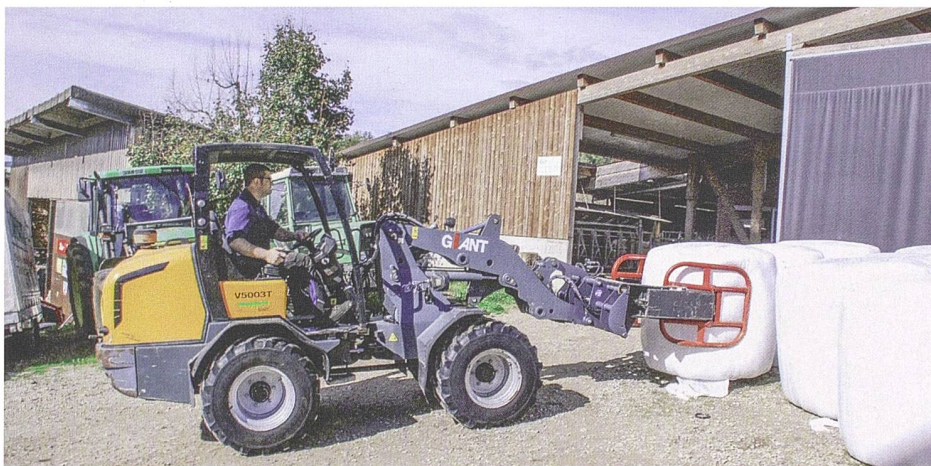
Mit dem «Highspeed Oil Coupler» lassen sich Anbaugeräte schnell an- und abbauen. Vor allem dann auch, wenn die Hydraulikleitungen unter Druck stehen. Bilder: H. Röthlisberger
