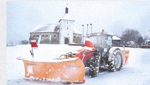
Rasco hat mit der «Kalnik»-Baureihe Schneepflüge im Programm, die für anspruchsvolle Räumungseinsätze mit grösseren Traktoren und Lastwagen geschaffen sind, werden doch grosse Schneemassen dank 1,2 m Pflughöhe und optimalem Auswurf mit Leich-
