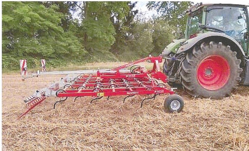
Gütter baut sein bodenschonendes Konzept zur Unkrautbekämpfung und Stoppelbearbeitung aus und bringt die seit zehn Jahren bewährte Federzahnegg «Super Maxx» nun mit sieben Zinkenreihen auf den Markt (Bild). Der Durchgang von Stroh und Pflanzenresten soll trotz dem vergleichsweise engen Strichabstand von 13 cm nicht beeinträchtigt werden. Zudem hat
