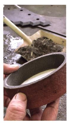
Der Spezialstein von Andreas Moser schleift locker 20 Messer, die Abnützung ist kaum sichtbar. Hinten in der Schaufel ist ein Teil des weggeschliffenen Metalls zu sehen.
