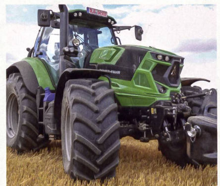
Das stufenlose Getriebe ist bei der Serie «7» – hier das Spitzenmodell «7250 TTV» – für eine Geschwindigkeit von 60 km/h ausgelegt.
