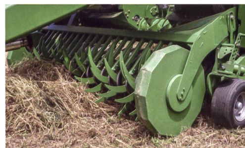
Dem Pick-up vorgeschaltet ist eine Rückhaltewalze mit groben Stahlzinken,
