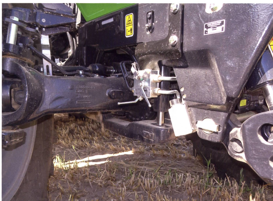
Die Federung der Vorderachse basiert auf dem Konzept der Längsschwinge und wird elektronisch gesteuert.
