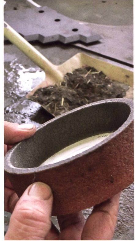
Der Spezialstein von Andreas Moser schleift locker 20 Messer, die Abnutzung ist kaum sichtbar. Hinten in der Schaufel ist ein Teil des weggeschliffenen Metalls zu sehen.
