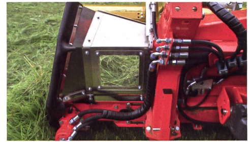
Beidseitig angebrachte Sichtfenster ermöglichen einen Blick vom Traktor aus aufs Förderband.
