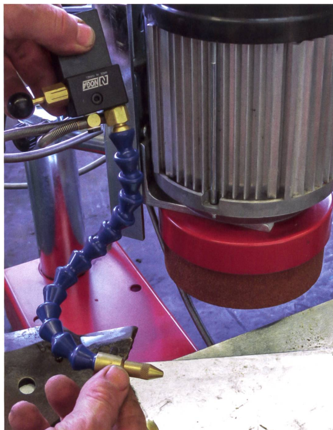
Die Kühlung erfolgt mit einem mobilen und effizienten Sprühnebelgerät, das mit Druckluft betrieben wird.
