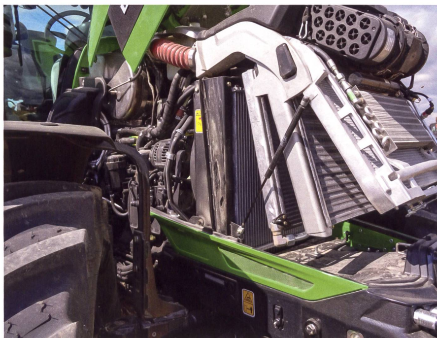
Mit dem neuen Motor wurde auch die Kühlung neu konzipiert: Aluminium soll die Wärme besser ableiten, dem Motorluftfilter ist ein Vorreinigungssystem vorgeschaltet.
