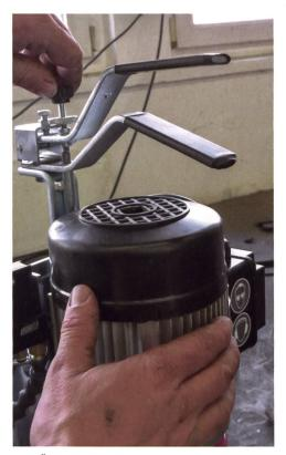
Über die Rändelschraube wird der Abtragvorschub eingestellt, alle 4–5 Schleifbewegungen eine halbe Umdrehung nachstellen ist optimal.
