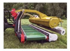
Der «Respiro R3» wird hydraulisch angetrieben und kann horizontal frei pendeln. Oberhalb des Pickups befindet sich der optional mit einem Rollenhalter ergänzte gelbfarbene Rotor.
