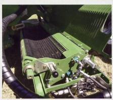
Anlässlich des Presseworkshops präsentierte Krone sein Angebot an Rund- und Quaderballenpressen. Neu vorgestellt wurde das «VariCut» für Quaderballenpressen. Dieses Vielmesser-Schneidwerk mit 51 Messern und sechs konfigurierbaren Messergruppen ermöglicht einen variablen Einsatz zur Erzeugung von kurzem Stroh und ist eine Alternative zum Vorbauhäcksler.
