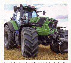
Das stufenlose Getriebe ist bei der Serie «7» – hier das Spitzenmodell «7250 TTV» – für eine Geschwindigkeit von 60 km/h ausgelegt.
