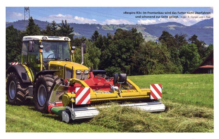
Mit zunehmender Arbeitsbreite steigt beim Kreiselschwader die Gefahr der Futterverschmutzung, weil das Gras lange über den Boden gezogen wird. Bandschwader wollen dies vermeiden, der durchschlagende Markterfolg blieb bislang aber aus: Gewicht und Preis waren stets begrenzende Faktoren.
