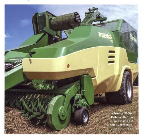
Sie war ein Star auf der Agritechnica 2015, wurde von Krone auch entsprechend propagiert und gewann eine goldene Auszeichnung im Neuheitenwettbewerb der Messe: Die Rede ist von «Premos 5000», dem weltweit ersten mobilen Pelletvollernter. Mit dieser Maschine können Halmgutpellets direkt aus dem Schwad auf dem Feld produziert werden.
