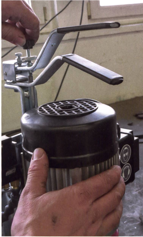
Über die Rändelschraube wird der Abtragsvorschub eingestellt, alle 4–5 Schleifbewegungen eine halbe Umdrehung nachstellen ist optimal.
