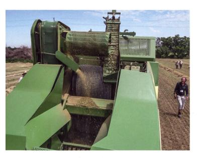
In der Mitte das Herz der Maschine, die beiden gegenläufig drehenden Lochmatrizen-Walzen. Die Pellets werden gesiebt und gelangen via innenliegende Schnecken und Förderband in den Bunker.
