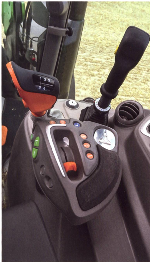
Bedieneinheit für das einfache Lastschaltgetriebe, für das automatisierte «RC-Shift»-Getriebe und für die stufenlose Variante.
