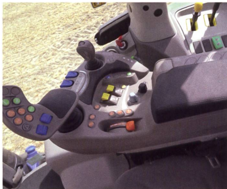
Bedieneinheit für das einfache Lastschaltgetriebe, für das automatisierte «RC-Shift»-Getriebe und für die stufenlose Variante.
