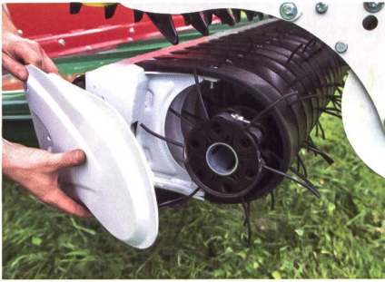
Das Pickup weist einen kleinen Durchmesser auf, hat sechs ungesteuerte Zinkenreihen. Die Zinken sind ohne Schrauben in Kunststoffhalbschalen fixiert.
