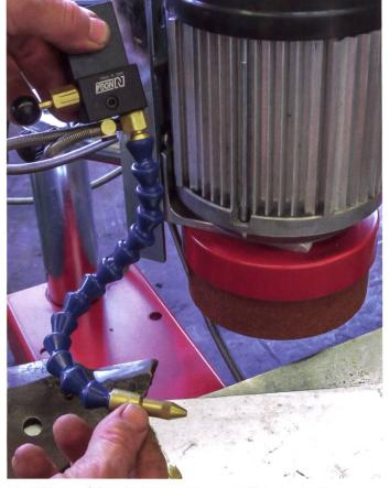
Die Kühlung erfolgt mit einem mobilen und effizienten Sprühnebelgerät, das mit Druckluft betrieben wird.
