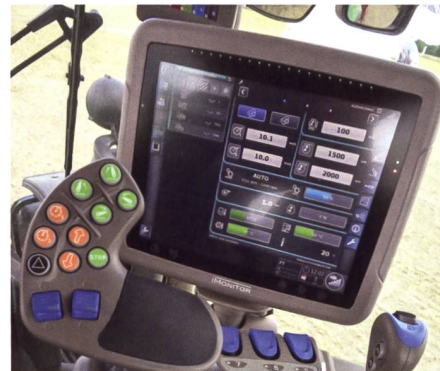
Bedieneinheit für das einfache Lastschaltgetriebe, für das automatisierte «RC-Shift»-Getriebe und für die stufenlose Variante.
