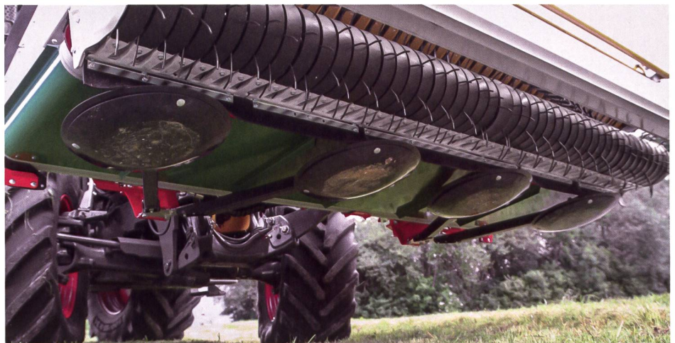
Vier rotierende Gleitteller sind für die Tiefenführung und Boden Anpassung des biege-elastischen Pickups verantwortlich.
