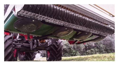
Vier rotierende Gleitteller sind für die Tiefenführung und Bodenanpassung des biegeelastischen Pickups verantwortlich.
