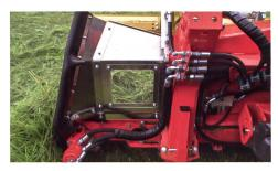
Beidseitig angebrachte Sichtfenster ermöglichen einen Blick vom Traktor aus aufs Förderband.
