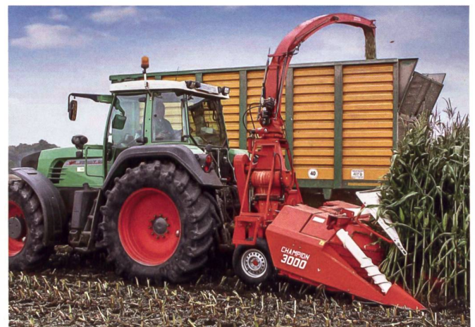
Kemper hat grosse Erfahrung im Bau von reihenunabhängigen Vorsatzgeräten für Selbstfahrer und rüstet deshalb auch die eigenen Anbauhäcksler damit aus.
