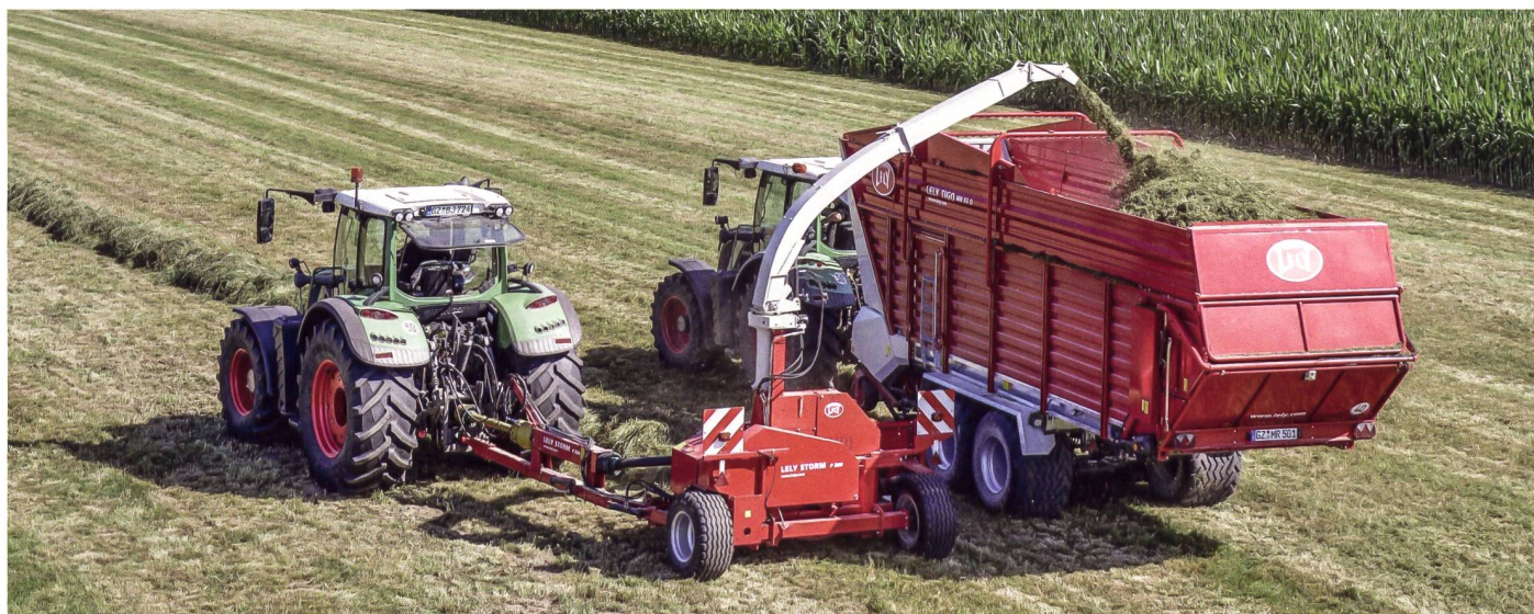
Gezogene Feldhäcksler können für den unabhängigen Grossbetrieb durchaus eine Alternative zum Selbstfahrer sein. Bilder: Werkbilder
