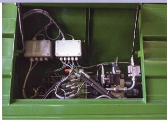
Im Anhänger ist die hydraulische Steuerung für den Antrieb der vier Räder untergebracht.
