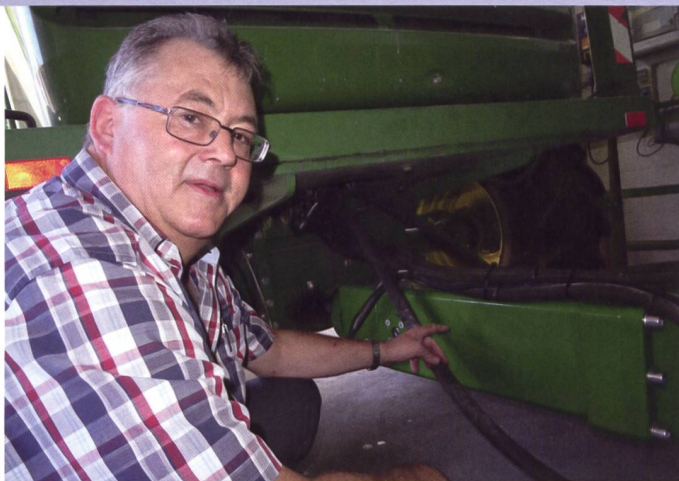
Peter Meier hat den Unterbau zum Wagen konstruiert und zeigt auf die Deichsel, wo der Sensor für die Zugkraftregelung integriert ist.
