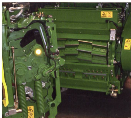
John Deere «ProCut» nimmt die direkte Abstandsmessung der Gegenschneide über ein induktives Messverfahren vor. Zudem ist eine automatische Schärfenmessung aller Messer einzeln möglich. Bild: R. Hunger
