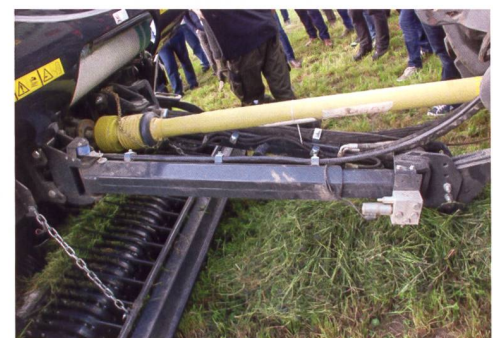
Das AutoFeed-Control-System gleicht unregelmässige Futtermengen automatisch aus.
