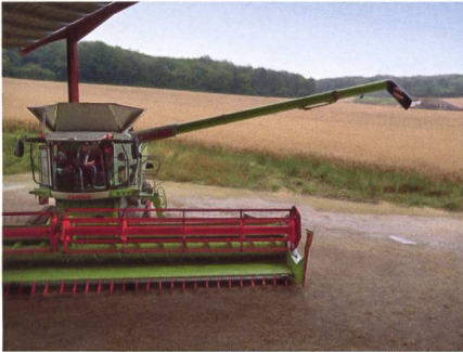
Die «Lexion»-Drescher gibt es nun mit 12 m langem Abtankrohr, sodass ein 12-m-Spur-system im Controlled-Traffic-Verfahren bearbeitet werden kann.
