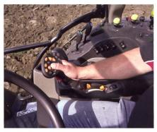
Die Bedienung wurde entschlackt, beinahe alles läuft über den Multicontroller und den Frontlader-Joystick.
