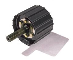
Neue Oberflächenrippung der Presswalzen mit geschraubter Antriebsflansche bei der «Rollant 620».
