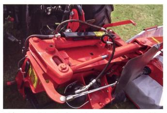
Bei den neuen Mähwerken kommt die Mähbalken-Entlastung «Lift Control» zum Einsatz. Das verbaute Parallelogramm leitet die Kräfte so ab, dass die Entlastung gleichzeitig auch als Anfahrschutz dient.
