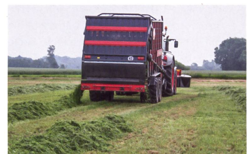
Förderbandaufbau beim «Rotex»-Ladewagen zur seitlichen Futterablage.
