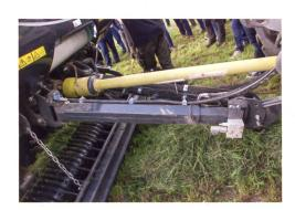
Das AutoFeed-Control-System gleicht unregelmässige Futtermengen automatisch aus.
