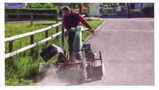
an der Oberfläche ab, sodass diese verdorren. Der Unterbau bleibt hingegen unbeschädigt, eine Nachlaufwalze erzeugt ein sauberes Arbeitsergebnis nach der Überfahrt.
