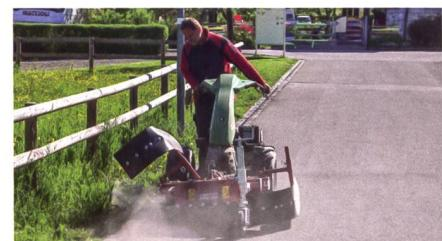
an der Oberfläche ab, sodass diese verdorren. Der Unterbau bleibt hingegen unbeschädigt, eine Nachlaufwalze erzeugt ein sauberes Arbeitsergebnis nach der Überfahrt.
