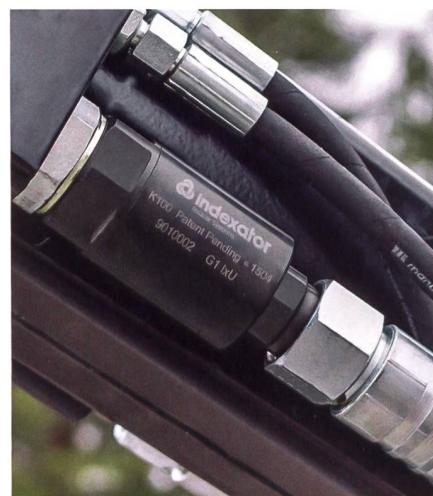
Die Drehverschraubungen der neuen Generation weisen einen niedrigen Drehwiderstand auf, was die Gefahr für Schlauchbrüche reduziert. Die «K100» überwacht zudem kontinuierlich die Schlauchbefestigungen und dreht sich bei Bedarf, um die Schläuche zu schonen. Zusammen mit der Möglichkeit für eine einfachere Schlauchführung mit kürzeren Längen steigt die Lebensdauer der Hydraulikschläuche.
