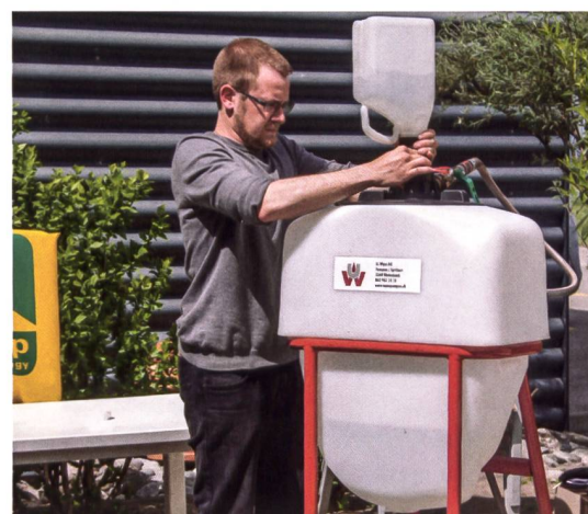
Der neue «Easy-flow»-Adapter bietet ein geschlossenes System beim Einfüllen des konzentrierten Pflanzenschutzmittels in den Tank und gewährleistet eine gefahrlose Kanisterspülung.
