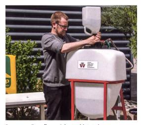
Der neue «Easy-flow»-Adapter bietet ein geschlossenes System beim Einfüllen des konzentrierten Pflanzenschutzmittels in den Tank und gewährleistet eine gefahrlose Kanisterspülung.
