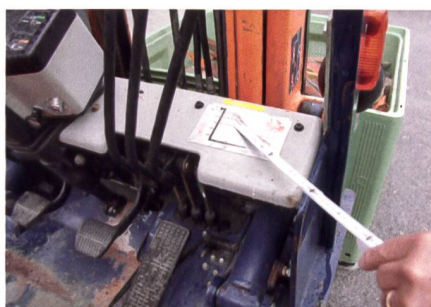
Das Diagramm auf jedem Staplerfahrzeug gibt klar und deutlich an, wo die Grenzen nach Massgabe von Gewicht und Schwerpunkt-lage sind. Moderne Geräte unterbinden vor dem Kippmoment eine verhängnisvolle Fehlmanipulation.
